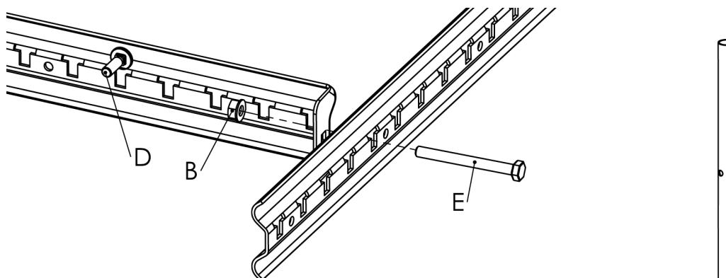
Montering av takbro maks. C-avstand konsoller 1200 mm. C-avstand mellom skorsteinsbåndene 320 mm.
